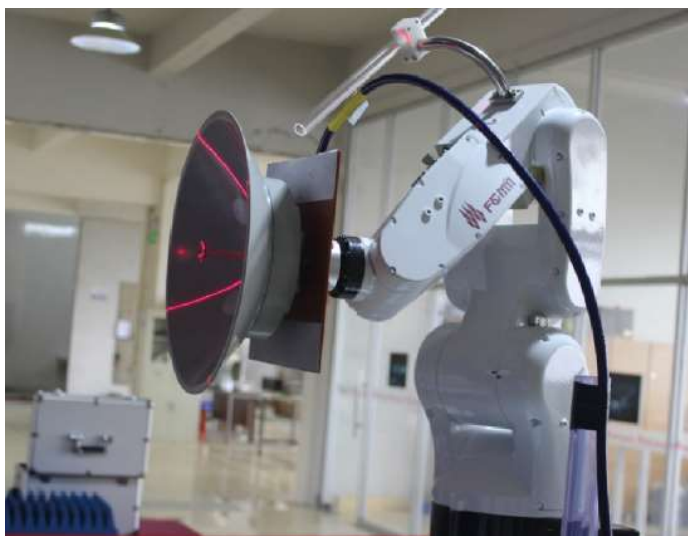
图 4 用于坐标校准的机器人控制激光工具包
