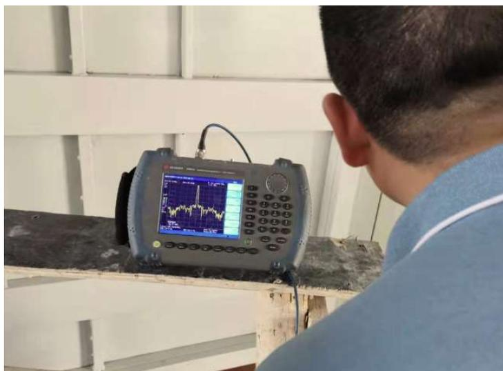
图 3 香山微波对暗室屏蔽质量的测量
