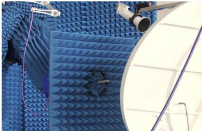
FM81 系统在室内用平面近场测量一款卫星天线。根据用户要求，研究了这款卫星天线的同极化和交叉极化的增益和辐射方向图。随着商业航天工业的快速发展，FM81 产品非常适合与低轨地球站天线、卫星天线、低轨卫星、轨道跟踪系统、微波链路系统、车载卫星通信单元、终端或高通量空间 5G 通信的有源 TR 模块相关的测量和校准工作。
